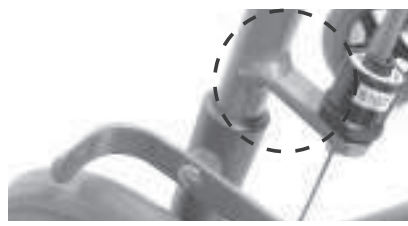
⑧ブレーキプレート部(左右2ヶ所) (交換が可能 ★参照)
