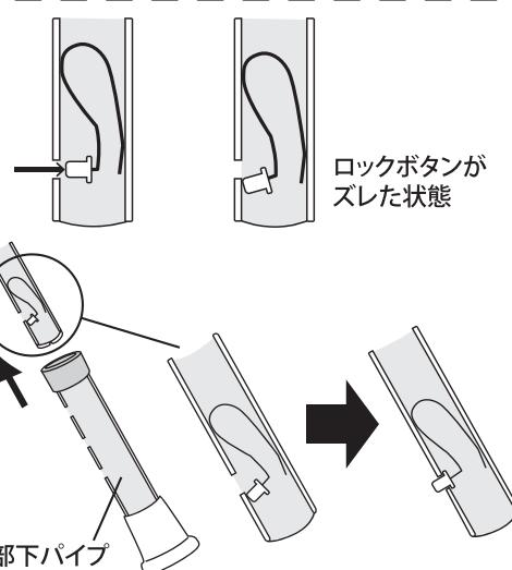
ロックボタンが脚部下パイプから出てこない場合(パイプの中にロックボタンが入りこんでしまった状態)、脚部下パイプを抜き、ロックボタンの位置を確認後、ズレを解消し、脚部下パイプをセットし直してください。
