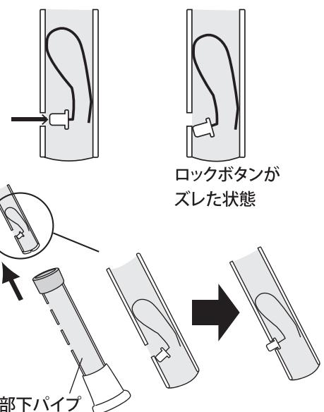
ロックボタンが脚部下パイプから出てこない場合(パイプの中にロックボタンが入りこんでしまった状態)、脚部下パイプを抜き、ロックボタンの位置を確認後、ズレを解消し、脚部下パイプをセットし直してください。
