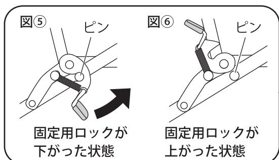
2. ハンドルと座面の2カ所を持って、内側にはさみ込むように折りたたみます。
