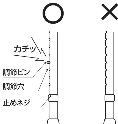
(注意) 止めネジを確実に堅く締めても、調節ピンを押すと簡単にスライドするときは、止めネジリング(止めネジの中に入っている部品)が抜け落ちている可能性があります。
