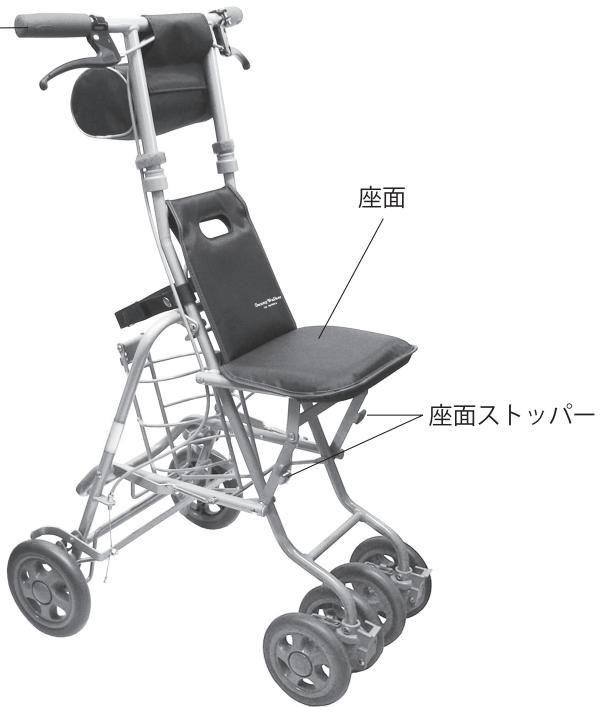
折りたたむときは、座面ストッパーを押手側に引くと座面がたためます。開閉用アームを持ち上げ、開閉用ロックで固定してください。
