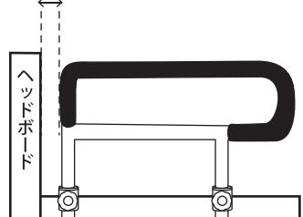
④ ベースのネジ付きパイプに、通した本体手すりの2本のパイプをゴムキャップの底までしっかりと差し込んでください。
