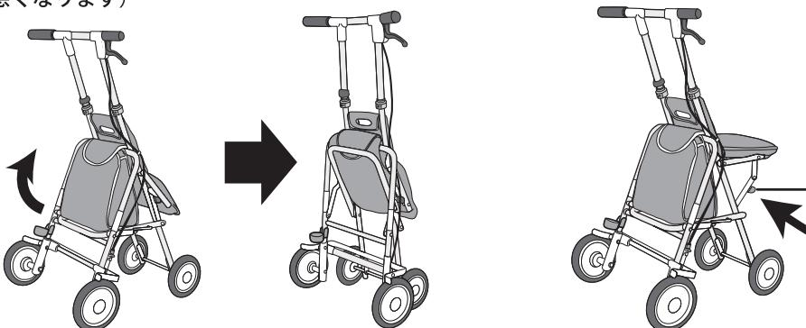
座面を使用していた場合は、矢印の方向に座面ストッパーを押して、座面をたたんでください。
